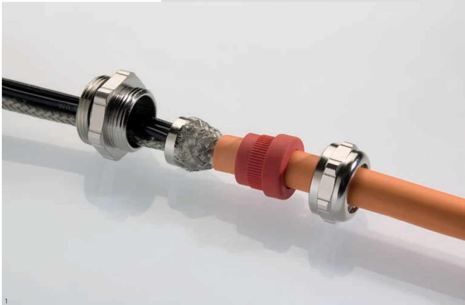
Abb. 1 – UNI Entstör Dicht – Schirmgeflecht liegt auf Konus auf. Fig. 1 – UNI Interference Suppression Dicht – braided shield on the cone
